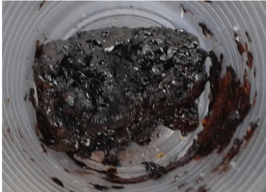
Muestra del producto de taponamiento del pozo
